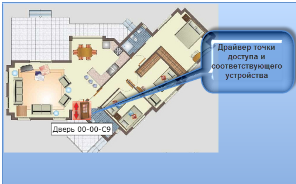
Рисунок 152 - АРМ RusGuard. Модуль Планы. Схема с размещенным на ней драйвером устройства "дверь"
