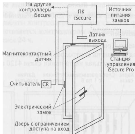
Рис. 4.8. Схема подключения контроллера в систему контроля доступа iSecure PRO Simplex
