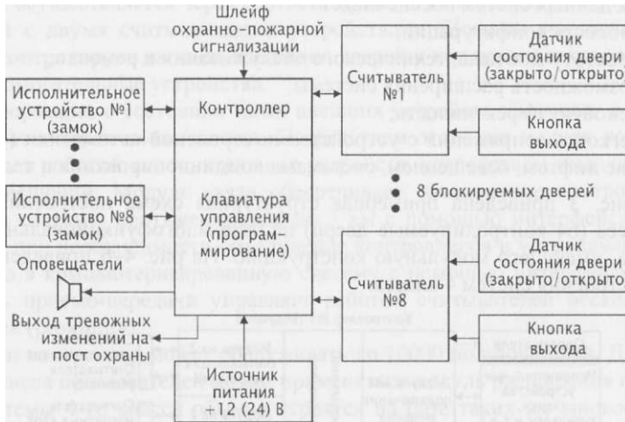
Рис. 2. Оборудование СКУД объекта с несколькими дверями
