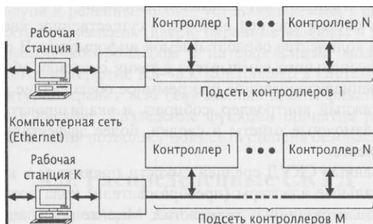
Рис. 4.5. Полная схема сети СКУД
